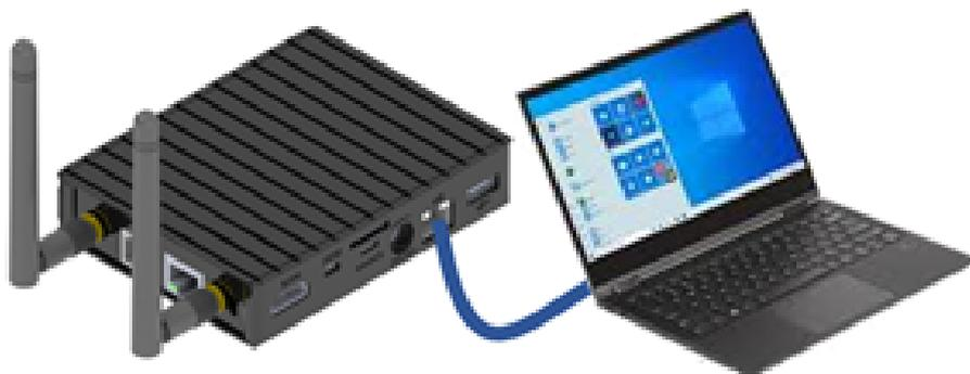
*Figura 6.1: Preparación para la configuración del Drive Scan via Ethernet*
